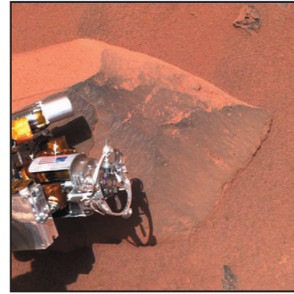
L'instrument RAT fixé sur le bras du rover Spirit, prélevant un échantillon du rocher Adirondack pour l'analyser.
