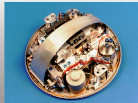
L'intérieur du capteur OPTIMISM. On remarque le ressort qui supporte la masse sismique, ainsi que son pivot. Mise sous vide et protégée par une enceinte en titane, cette partie est supportée par un cardan assurant la mise à poste.
